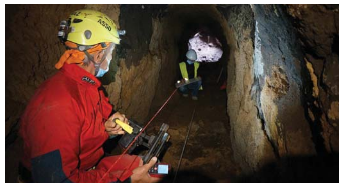
Foto: Marco Vitelli - Tecnici e archeologi ASSO effettuano il rilievo speditivo di un antico acquedotto.
