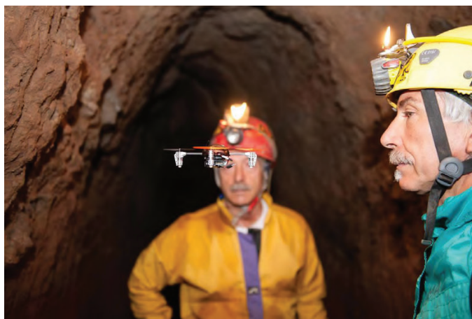
"Bimbo" il micro drone realizzato da Marsala per le verifiche di spazi ristretti in ambienti sotterranei archeologici (foto Massimo Crescenzi)
