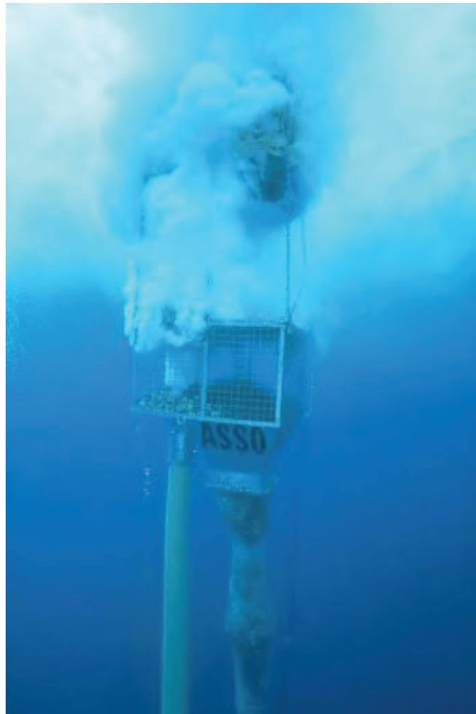
Lo scarico della sorbona ad aria impiegata nello scavo dell'antico relitto della Secca dei Mattoni presso l'Isola di Ponza (foto: Marco Vitelli)
